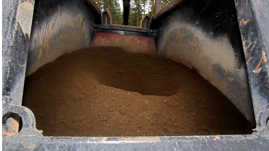
Askan är vattenbehandlad och dammar därför inte. Ett transportband i botten av baljan för askan bakåt mot spridarna. Foto: John Thorner.
