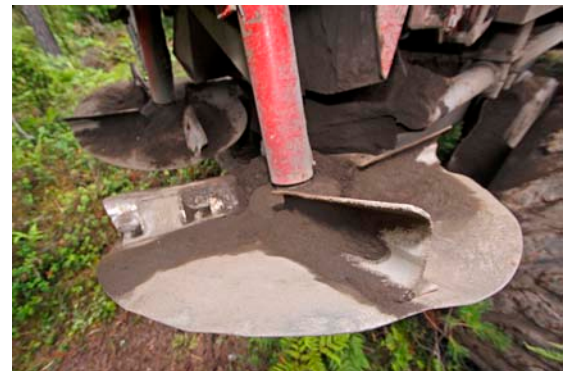
Enkel teknik. Bak sitter två spridningstallrikar som slungar ut materialet bakåt och ut mot sidorna. Foto: John Thorner.
